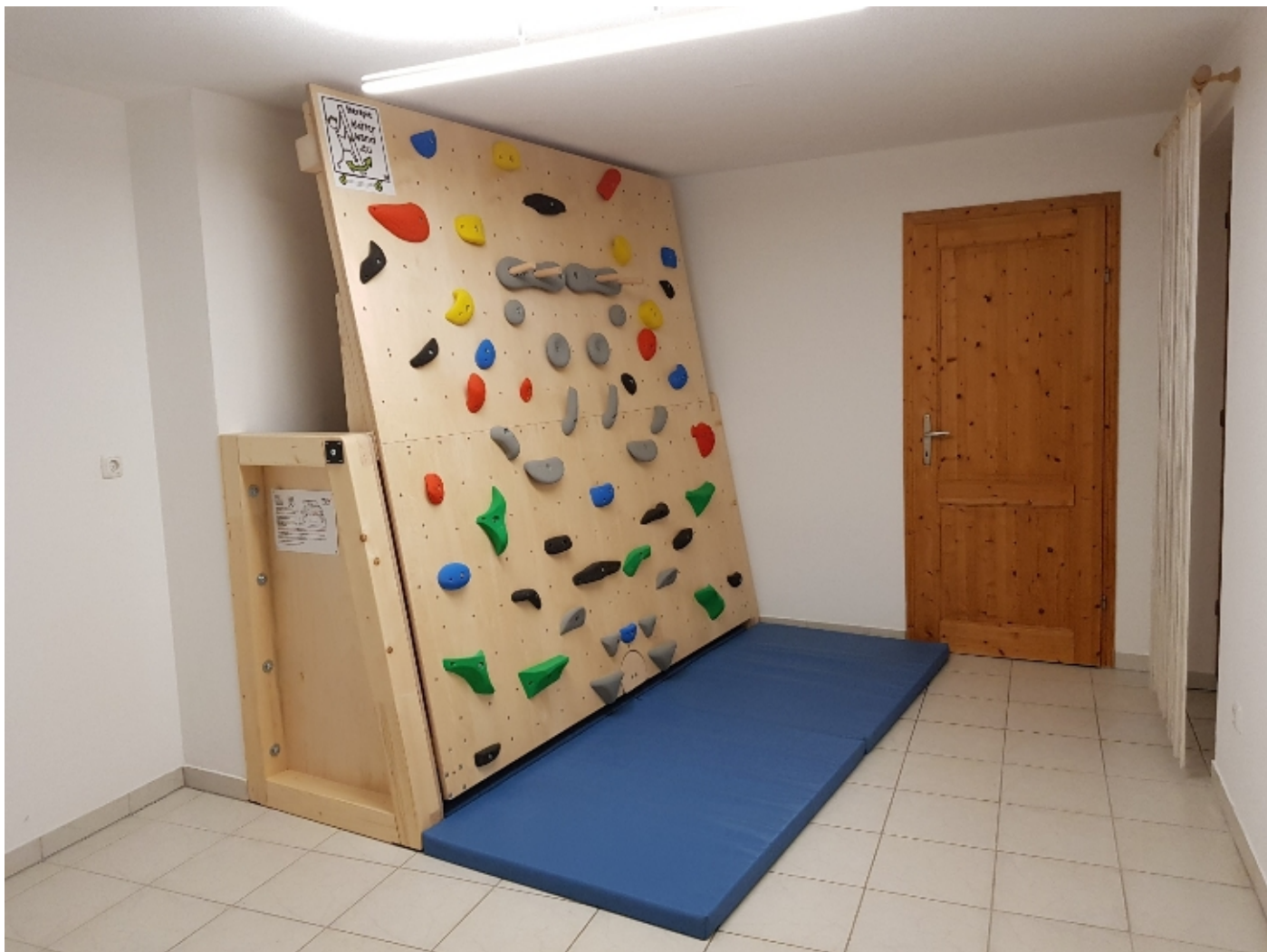
Abbildung 13, Physio Schachner Weiz, Stmk, Verstellbereich -20^{\circ}/+10^{\circ} in 5^{\circ} Schritten, Befestigung an der Raumwand
