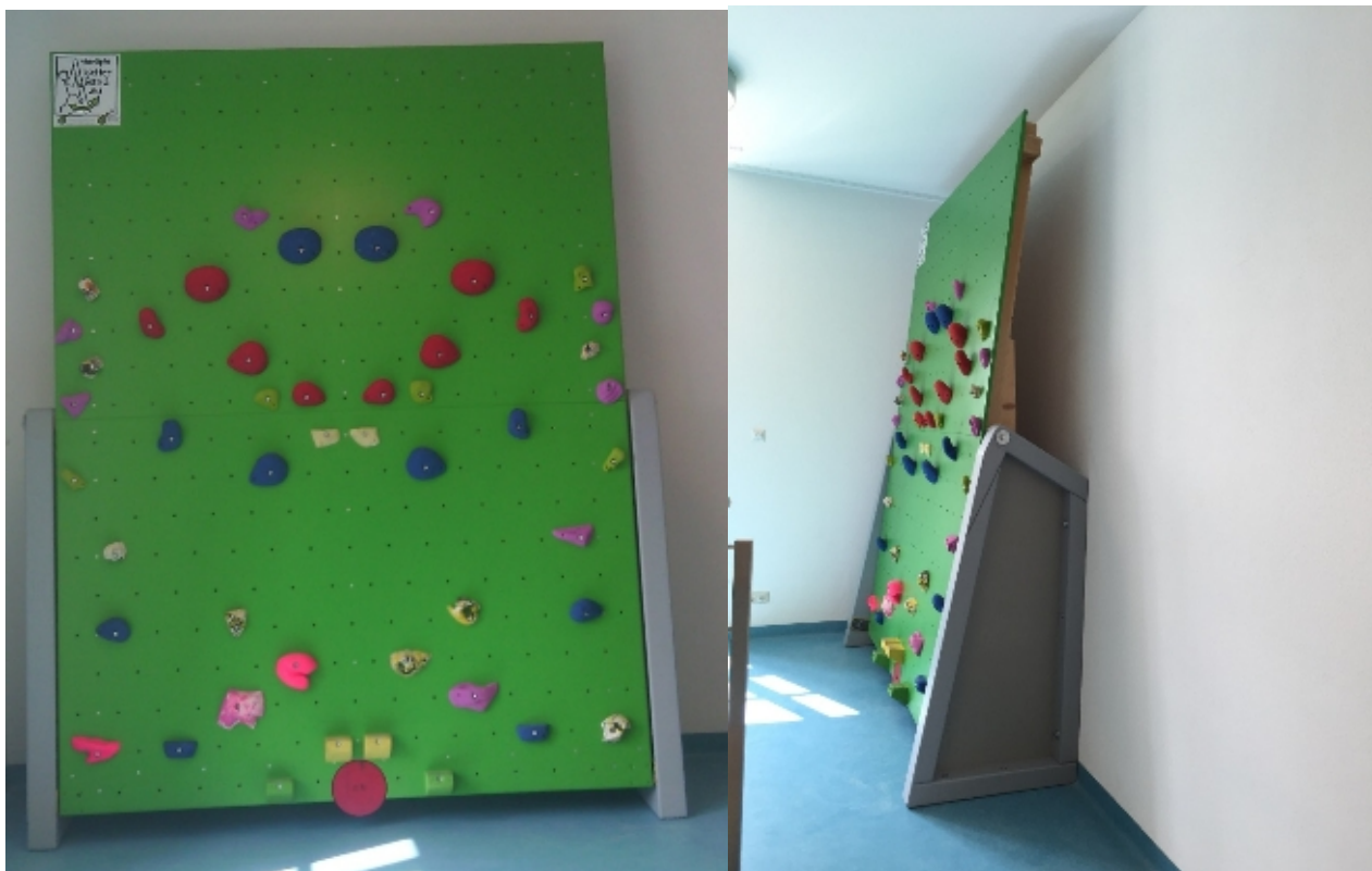
Abbildung 10, +/-10° Verstellbereich montiert an Wand und Boden - neuer Physiobereich Ybbs/Donau
