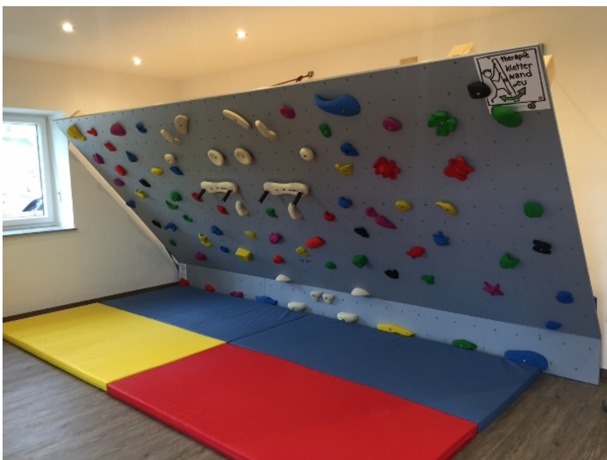
Abbildung 28, 4,5m breite Ausführung bis an die Seitenwand gebaut, mit redundantem Stahlseilssystem www.therapieraum.com – 4814 Altmünster/Traunsee, OÖ
